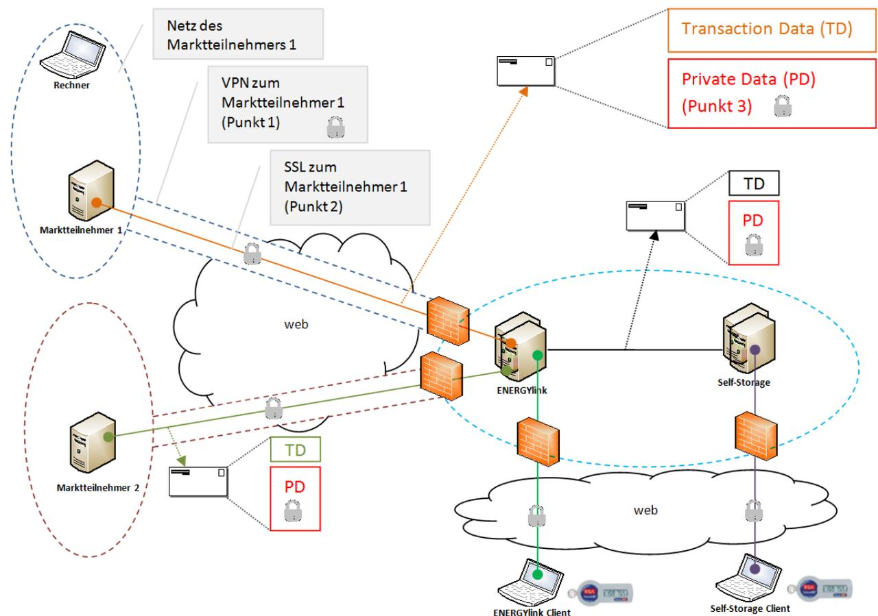
Dieses Konzept erfüllt die Anforderungen des Schöller Securitykonzepts für eine dezentrale Wechselsplattform der CISMO, da die PD vom logischen Sender für den logischen Empfänger verschlüsselt werden und die Steuerungsdaten im ebXML Header vom technischen Sender für den technischen Empfänger via SSL verschlüsselt werden.
